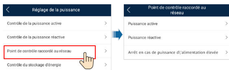
Figure 7-5 Contrôle de point raccordé au réseau
